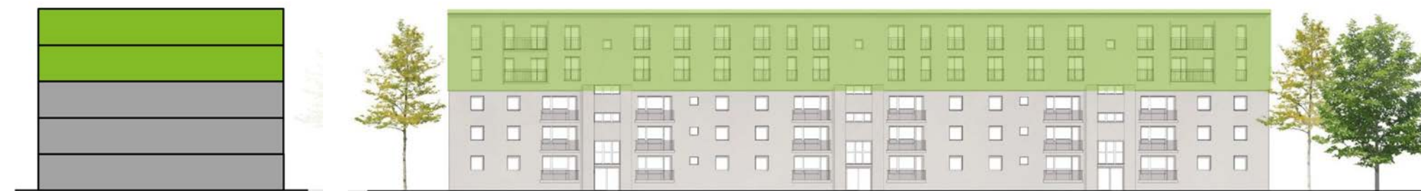
Fassadenansicht: Frankfurt Platensiedlung nach Aufstockung um zwei weitere Geschosse
